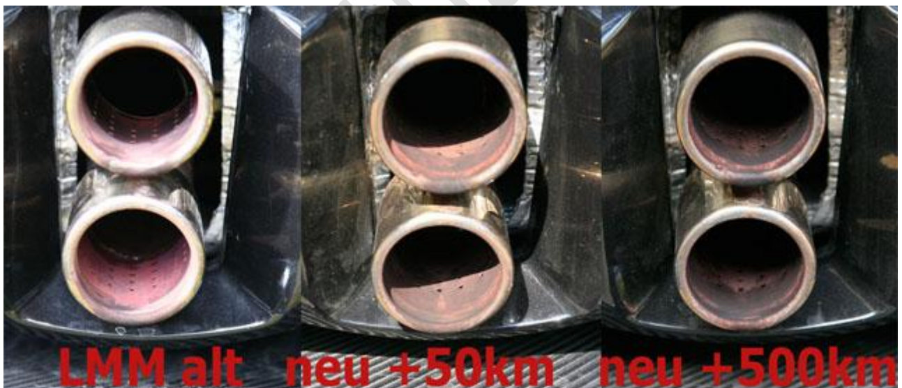
Endrohrfarbe bei defektem und neuen Luftmassenmesser
